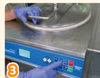
3 在料桶中以 72°C 殺菌，同步將固形物打散進行食材分子重組，讓味道融合。完成後降溫至 7°C，攪拌凍結。
