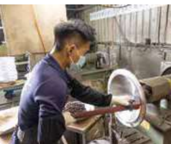
不鏽鋼鍋在壓模成型後以人工拋光，使其表面平整光滑。
