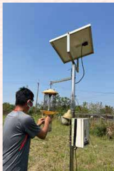
《營農型光電政策研究》計畫採訪農民，農民自行架設的太陽能捕蟲燈白天蓄電，晚上捕蟲。（主婦聯盟基金會提供）
