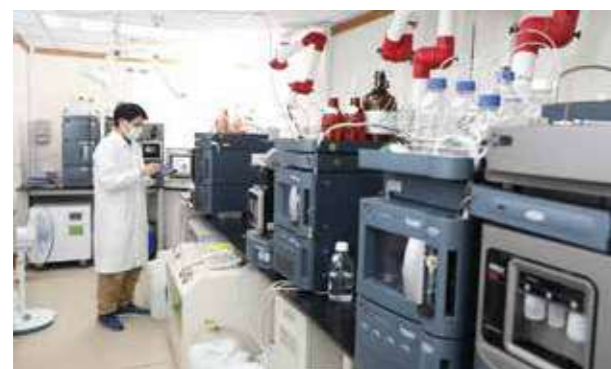
操作如檢測農藥的液相層析串聯質譜儀此類精密儀器時，需小心維持環境潔淨及定期維護保養，以免影響準確性。
