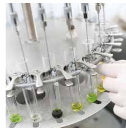
在檢測分析前，須將檢體的萃取溶劑置換成儀器可耐受的溶劑，避免儀器受損。
