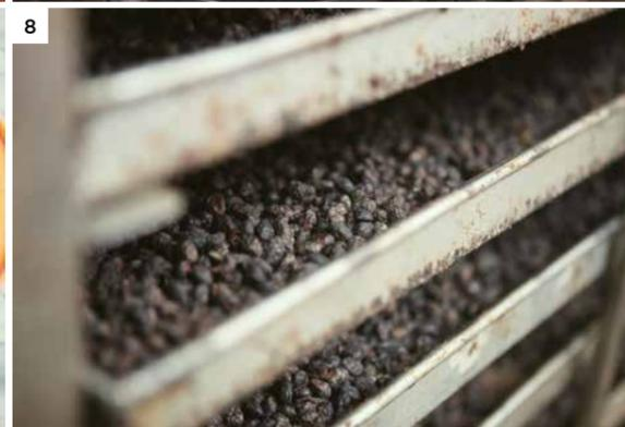
5 豆子洗淨後放入「蒸煮機」蒸煮20分鐘後排入籠車，直至溫度降溫至35°C以下，再裹上麪粉。6 裹上麪粉的豆子靜置在麪室托盤上5至7天分解蛋白質。托盤原為竹製，後來為防竹屑脫落，全面改成不銹鋼。間隔托盤的木頭從鄭惠民父親1962年開始經營醬油廠使用至今。7 本土黑豆瓣醬以新鮮的辣椒醃製，保留辣椒的果膠成分，先絞碎後定期攪拌。
