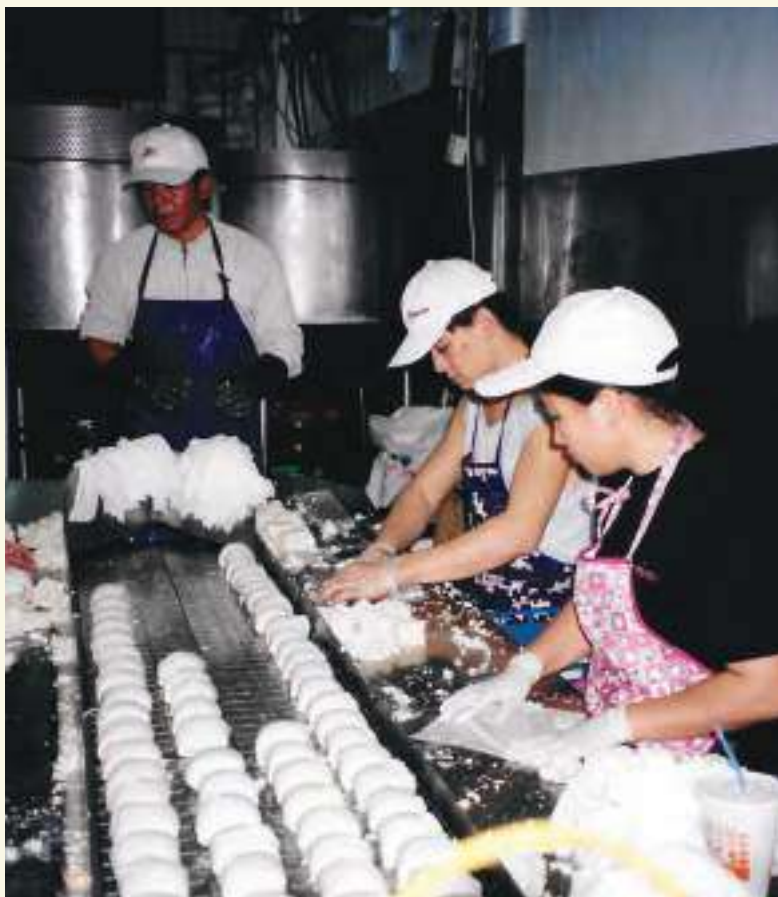
綠主張手工白豆干生產線，每塊豆干都是手工以紗布包裹，再加壓去水，紗布須每天徹底清洗晾乾。
