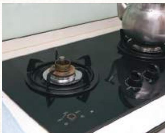
瓦斯爐的防乾燒裝置，當鍋子放上爐頭，會壓下中間的溫度探測器，一旦燒乾，溫度上升超過設定溫度，就會自動關閉瓦斯。
