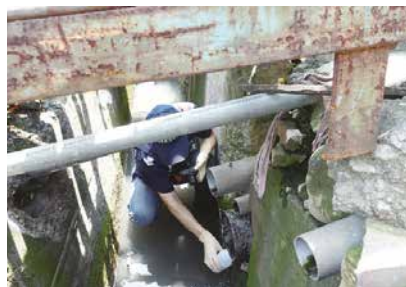
環保署中區督察大隊於事業雨水管進行廢水採樣檢測，攝於2016年4月21日。(攝影/環保署提供)
